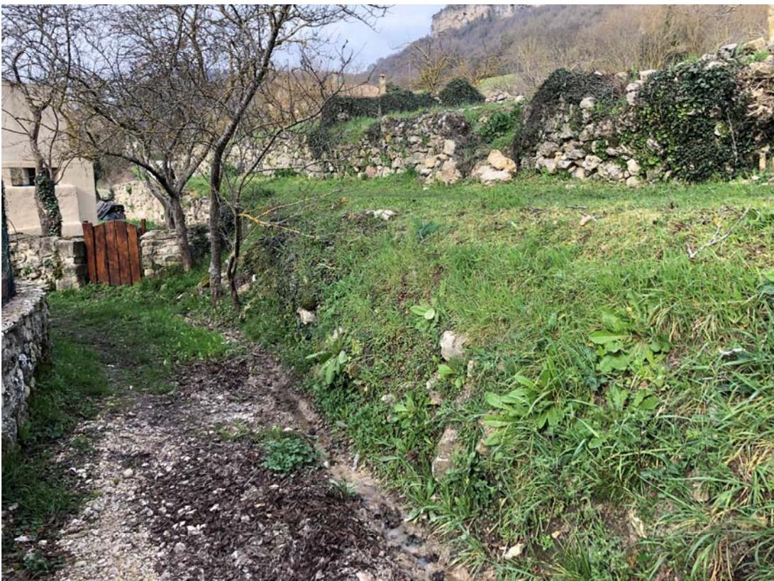
Calle de acceso peatonal a regularizar en su parte norte (muro a reconstruir). Se aprecia la discontinuidad en sección transversal, que impide la modificación de rasantes para ampliación de sección hacia el sur.
